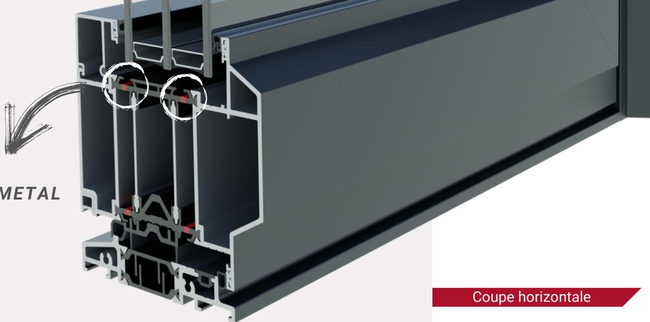
Les portes Decalu110 STEEL est une variante du Look Acier un visuel de bâtiments industriels. Le système bimétallique intégré unique dans le vantail de porte, empêche les profilés de se déformer en cas de chaleur intense. Ce ouvrant avec une excellente valeur d'isolation et son look élégant, est également possible avec double ou triple-vitrage. Un  $U_f$  à partir de  $1.30 \text{ W}/(\text{m}^2\text{k})$ .
