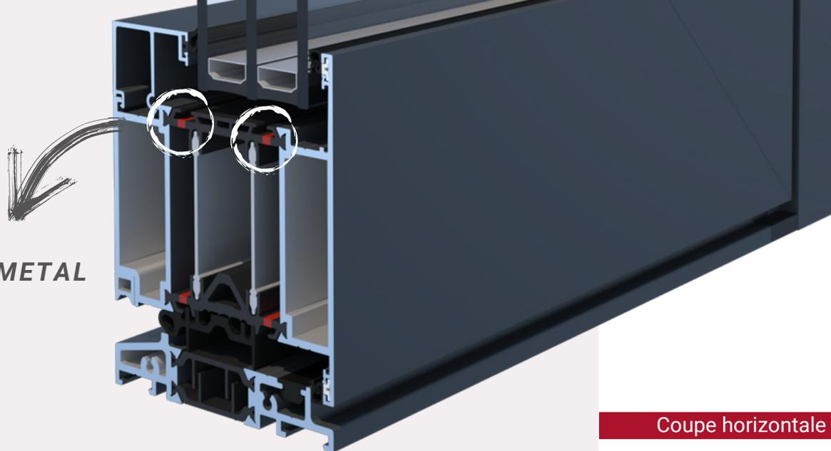
Les portes Decalu88 STANDARD sont un système de porte à «Affleurante» conçu pour la construction moderne. Le système bimétallique intégré unique dans le vantail de porte, empêche les profilés de se déformer en cas de chaleur intense. Ce ouvrant avec une excellente valeur d'isolation et son look élégant, est également possible avec double ou triple-vitrage. Un Uf à partir de 1.30 W/(m²k).
